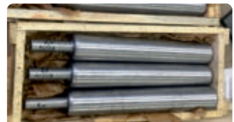
Плунжеры насосов перекачки суспензии НПЗ
