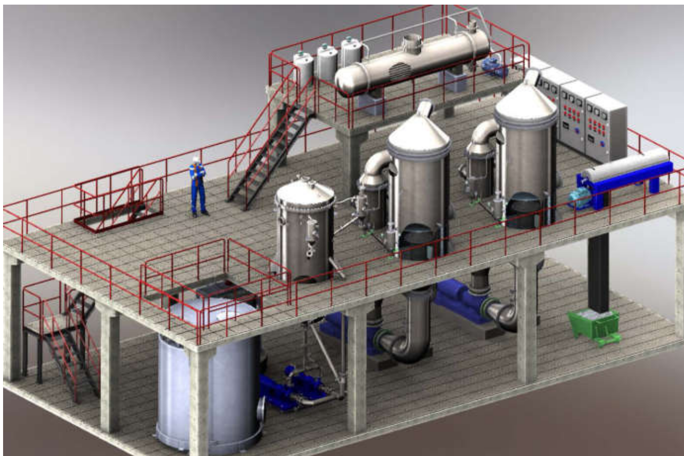
Рисунок 3а. Установка для очистки концентрированных сточных вод объемом от 3,0 до 10 м 3 /час
