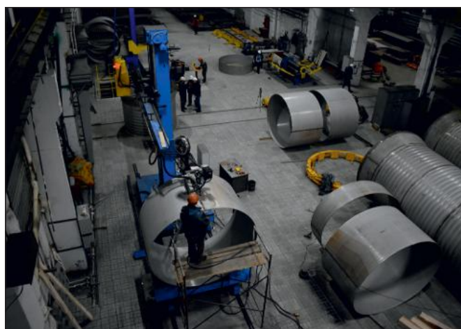
Установка сварки под флюсом
